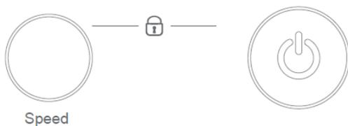
Ako istodobno držite pritisnute tipke Speed i Power 5 sekundi, aktivira se funkcija Dječje zaštite (blokada upravljanja). Nakon zvučnog signala ostale tipke postaju nefunkcionalne. Da biste deaktivirali funkciju, istodobno pritisnite obje tipke na 5 sekundi.
